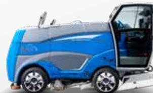
Schneetank: 3 m<sup>3</sup> (komprimiert 3,7 m<sup>3</sup>)
