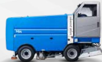
Schneetank: 4,1 m<sup>3</sup> (komprimiert 5,1 m<sup>3</sup>)
