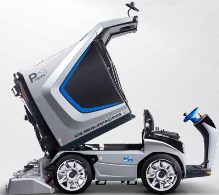
Hydraulisch kippbarer Schnee-/Wassertank
